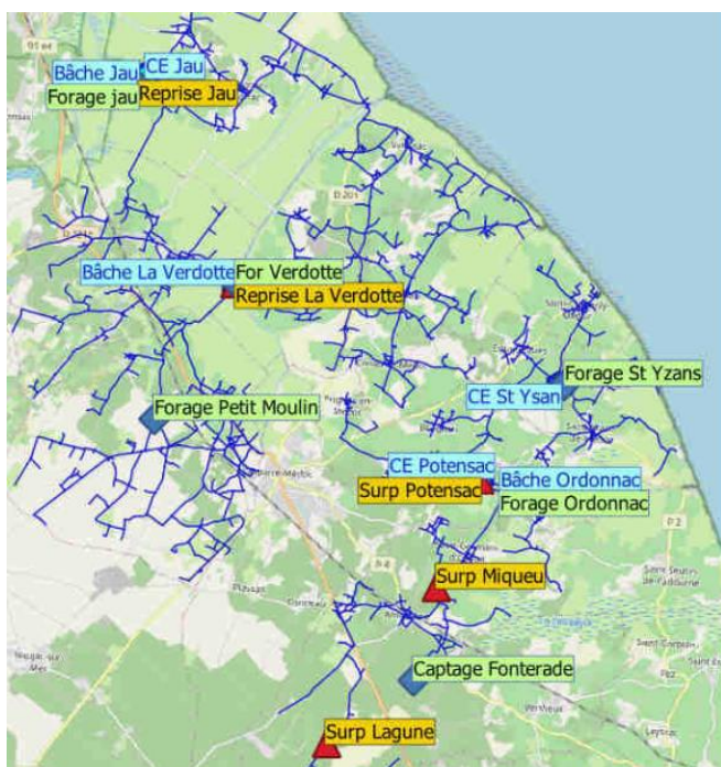
Réseau de distribution AEP (source : RPQS 2021)
